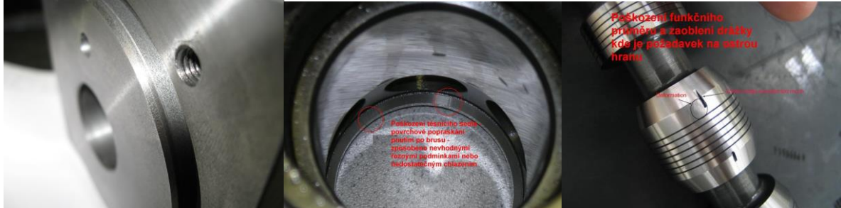
NOK schodek od nástroje na funkčním průměru
