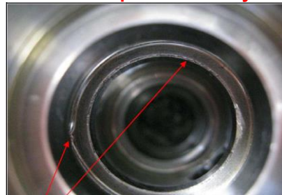
NOK poškození ostré hrany
