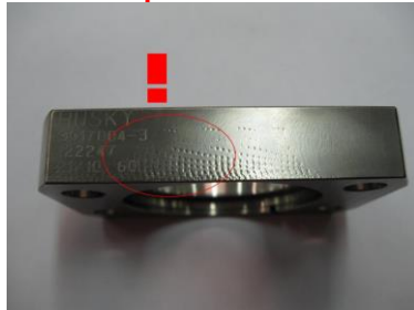
NOK poškození – dodrnčení od nástroje
